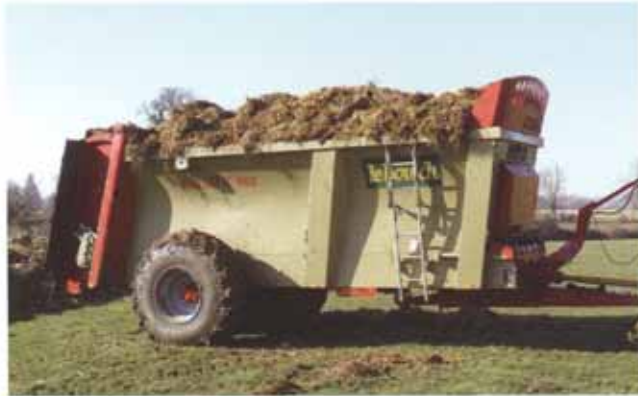
Nouveau profil de caisse avec protection renforcée des composants et tendeur hydraulique de tapis
